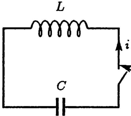
Рисунок 3 –Колебательный электрический контур
